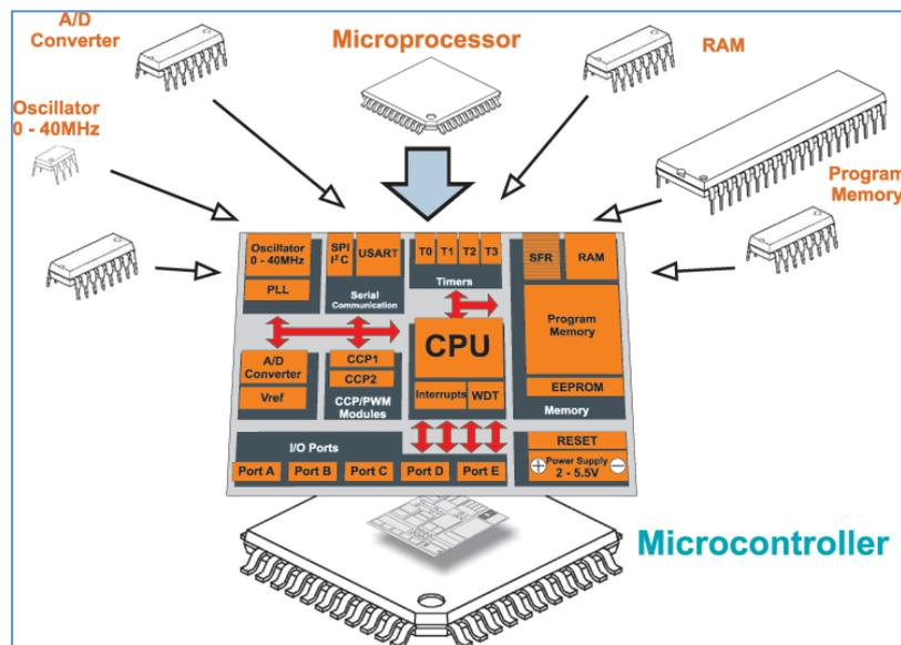
Si noti che generalmente il MCU non viene collegato a chip di memoria esterni (a differenza del microprocessore): l'intero programma di gestione del MCU e i relativi dati devono dunque risiedere sulla memoria interna integrata on chip.
