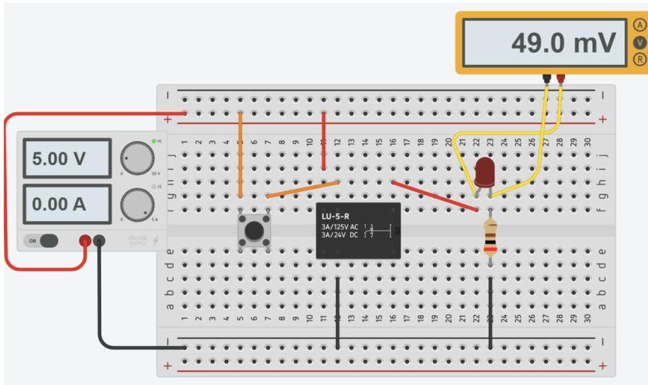
Premendo il bottone viene chiuso il circuito che comanda il LED. I due terminali gialli cerchiati del RELE' vengono connessi.
