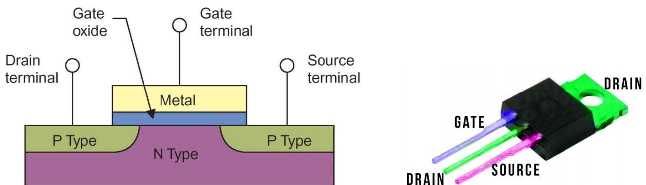
Il principio fisico su cui si basa è diverso rispetto a quello del BJT. I terminali sono sempre tre, cambiano solo i nomi: qui abbiamo gate, drain e source.
