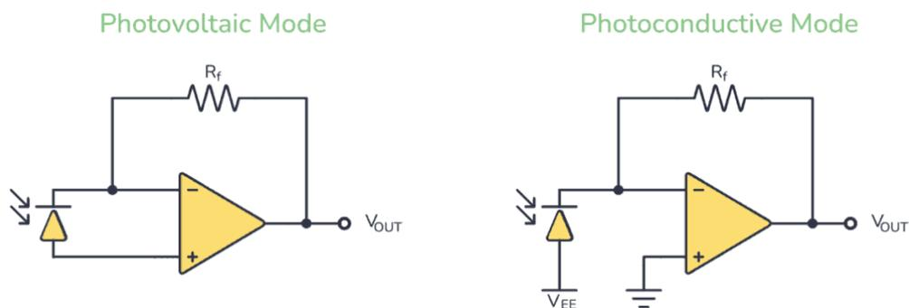
Nel circuito fotovoltaico si collega il fotodiodo in modalità polarizzata direttamente. L'anodo del fotodiodo è collegato al terminale non invertente e il catodo al terminale invertente dell'amplificatore operazionale. Quando la luce cade sul fotodiodo, genera una piccola tensione e corrente. L'amplificatore operazionale lo amplifica ed emette una tensione.
