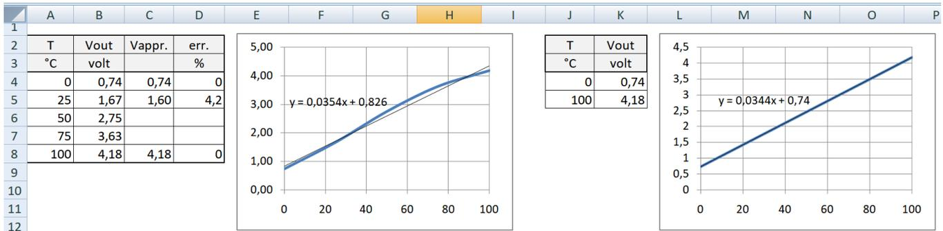
L'andamento della tensione nel campo di temperatura 0-100 è quasi lineare e di conseguenza lo sarà anche la variazione del numero di giri del motore in funzione della tensione del partitore.
