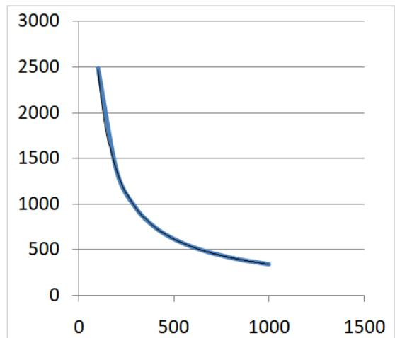
Il legame fra la resistenza R (ohm) e l'intensità luminosa (lux) non è lineare.
