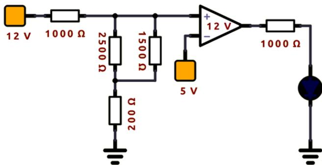
2- Dimensionare la  $R_b$  e la  $R_d$  per avviare il motore DC e per accendere il LED.
