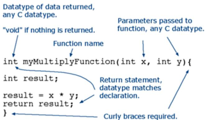
Per "chiamare" la nostra semplice funzione di moltiplicazione, le passiamo parametri del tipo di dati che si aspetta:
