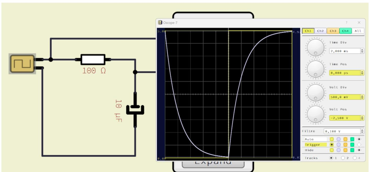
Più alta è la capacità C e più lentamente il condensatore si scarica quando non è alimentato.
