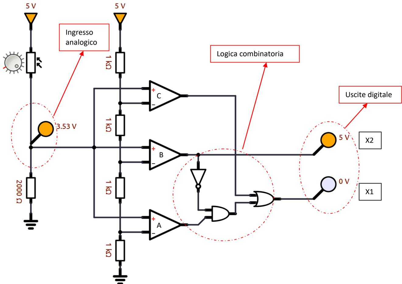
Il partitore multiplo (costituito da 4 resistenze a 1K) crea tre livelli di tensione in ingresso ai 3 comparatori. Quando la tensione in uscita al sensore supera questi livelli l'uscita del comparatore corrispondente va alta. La rete logica fa in modo che le 8 possibili combinazioni di A,B,C vengano ridotte a sole 4 combinazioni digitali.
