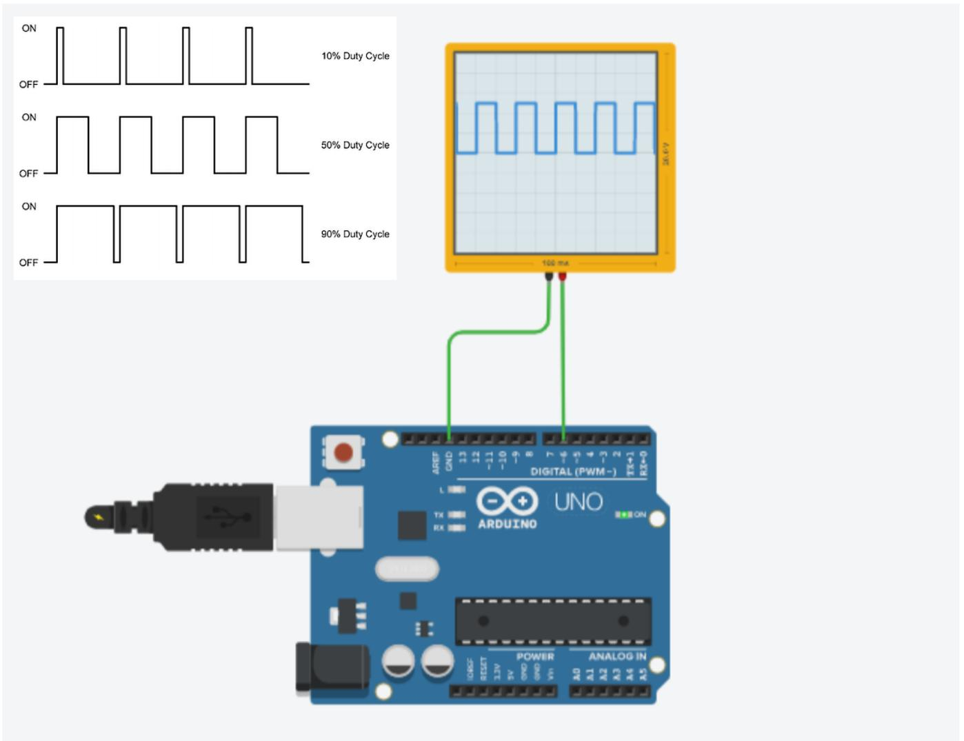
L'onda quadra è un segnale digitale che funziona con livelli logici alternati: 1 (massima ampiezza) e 0 (minima ampiezza). Viene utilizzato come riferimento temporale nei segnali di clock e nei computer nella trasmissione seriale di informazioni sulle reti di computer.
