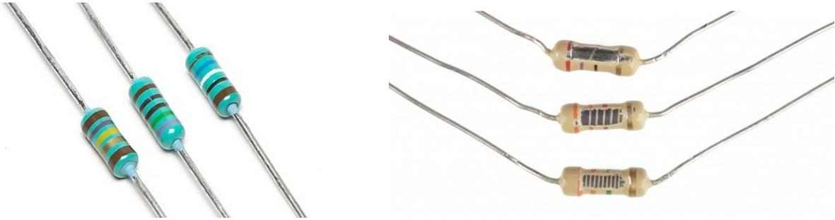
Nel caso in cui i resistori non abbiano i valori numerici stampati su di essi, si utilizza un codice a colori, che per i resistori fissi sono definiti dalla EIA, tramite la "Tabella codici colori EIA-RS-279".
