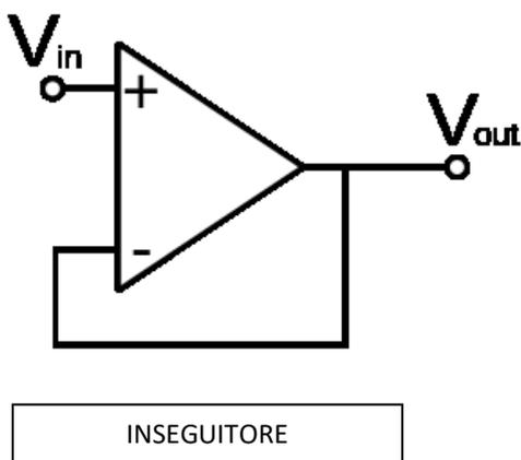
Tipicamente, un amplificatore separatore viene impiegato nel trasferimento di una tensione da un primo circuito, ad elevato livello d'impedenza, ad un secondo circuito, a livello d'impedenza inferiore.
