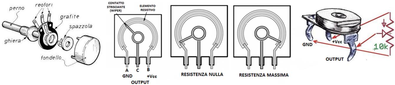
Può essere usato per generare un segnale di controllo analogico (0-5V) per regolare degli attuatori (es. luminosità di un LED, velocità di un motore ecc.).
