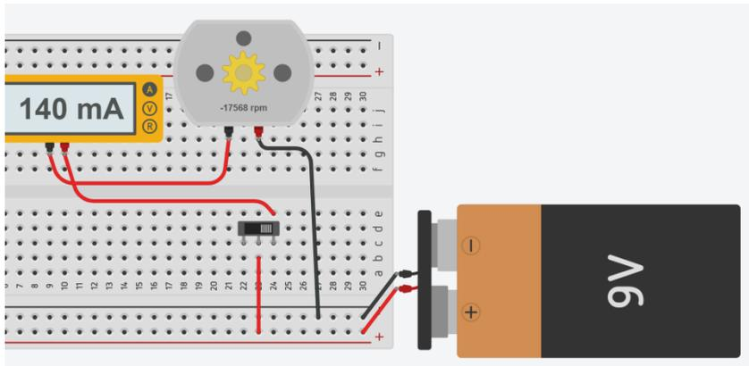
Si procede per tentativi variando il valore della resistenza inserita fino a quando la corrente diventa 100mA. Il voltmetro permette di rilevare la caduta di tensione sul resistore e di conseguenza quella sul motore.
