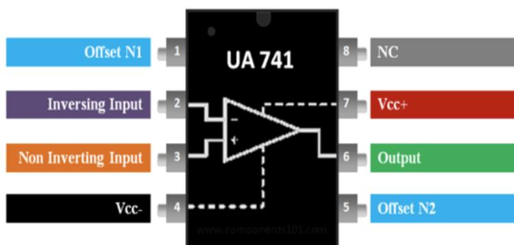
L'immagine estratta dalla scheda tecnica dell'elemento ci dice che la tensione massima e minima in uscita non sarà mai pari a Vcc e a 0V . Tipicamente varierà da un minimo di 0.5V ad un massimo di Vcc-2.2V (comunque variabili in base al costruttore).
