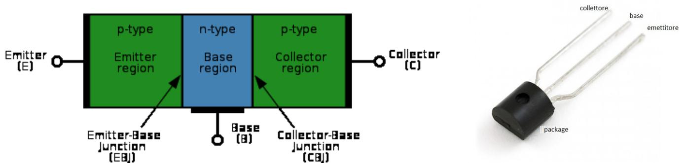
I terminali delle tre regioni vengono metallizzati per creare i contatti che successivamente usciranno dal package del componente per poter essere saldati sulla scheda elettronica.
