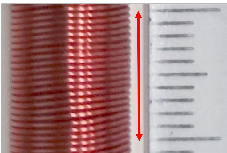
La bobina è alta 33mm, ha un diametro 9mm. Presenta 22 spire in 1cm, il d del filo è 0.4mm. La resistenza del filo della bobina è trascurabile:
