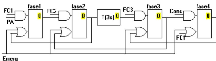
E' subito evidente che vi sono 4 fasi, e dovrebbero anche apparire chiare le condizioni per l'attivazione di ciascuna di loro. E' ad es. facile riconoscere che si entra nella fase1 (inizio della sequenza automatica) con il pulsante di avviamento PA, ma solo se c'è anche la presenza del segnale del finecorsa FC1 (che indica che tutto è a posto per iniziare).
