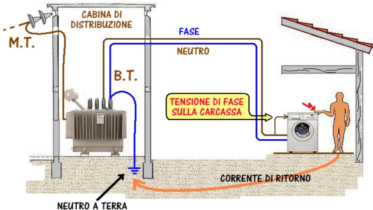
Se una persona accidentalmente tocca la carcassa della lavatrice, il suo corpo si trova a fare da circuito di ritorno: la corrente in arrivo, invece di rientrare al trasformatore percorrendo l'altro filo, attraversa il corpo dello sfortunato e ritorna alla cabina attraverso la terra; nella cabina di distribuzione, infatti, il neutro è collegato a terra.
