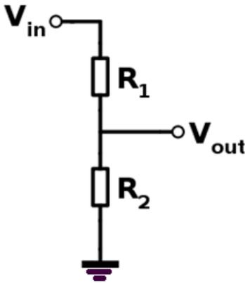
A 0°C la tensione in uscita la partitore vale 2,5V ( $R_s=R_2=100$ ).
