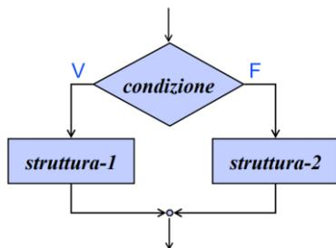
verifico la condizione e se il risultato è vero passo ad eseguire le istruzioni sul ramo corrispondente a vero, altrimenti passo ad eseguire le istruzioni sul ramo corrispondente a falso
