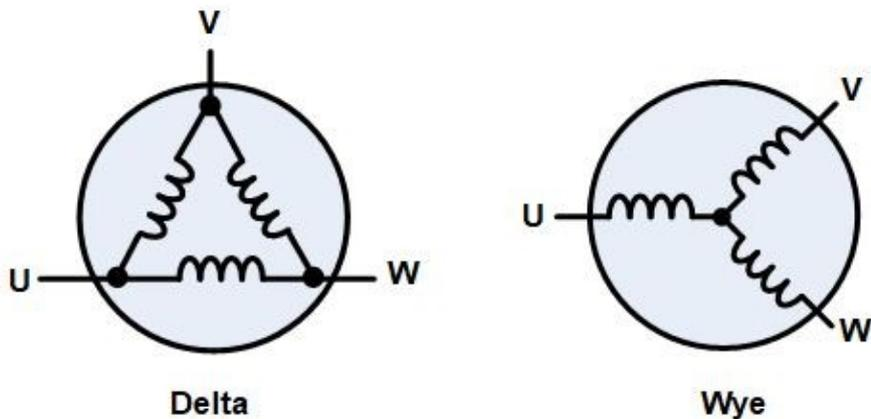
La corrente assorbita nel collegamento a triangolo è 3 volte quella assorbita nel collegamento a stella. Di conseguenza anche la coppia motrice è 3 volte maggiore.
