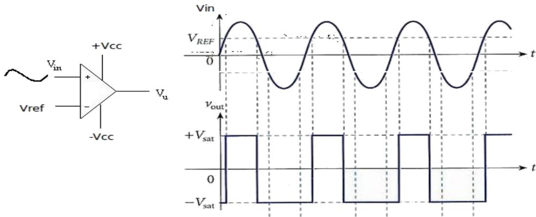
Risulta molto utile tutte le volte che si vuole attivare un attuatore (lampadina, motore ecc.) quando il segnale fornito da un sensore supera un certo valore di soglia  $V_{ref}$ .
