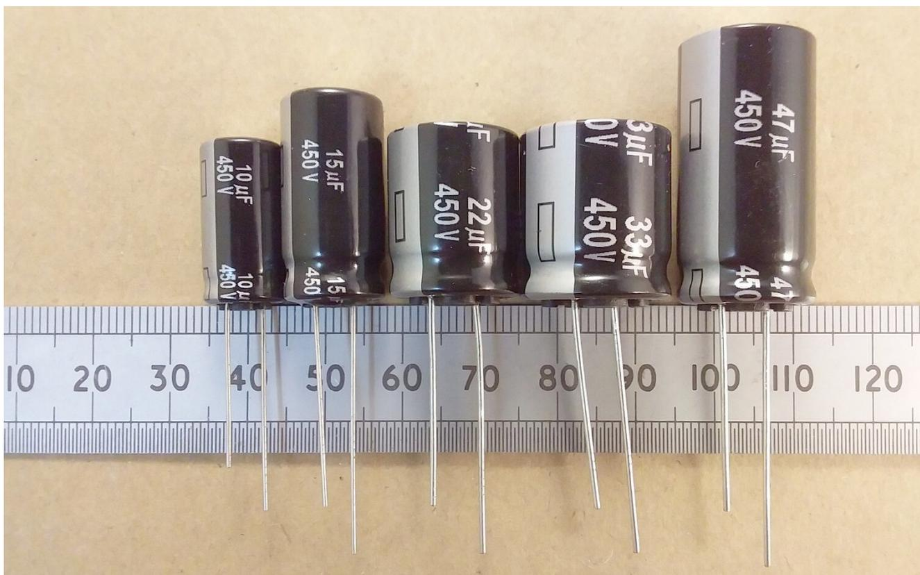
All'aumentare della capacità aumenta la dimensione cioè la quantità di carica elettrica accumulabile.
