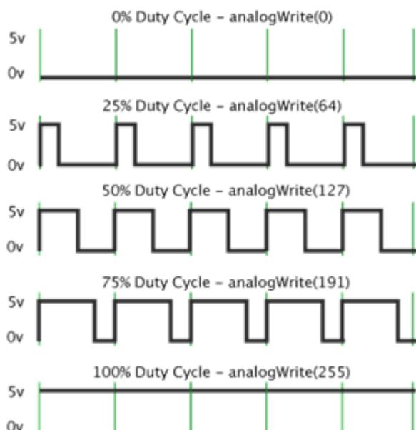
La modulazione di larghezza d'impulso (o PWM, acronimo del corrispettivo inglese pulse-width modulation) è un tipo di modulazione digitale che permette di ottenere una tensione media variabile dipendente dal rapporto tra la durata dell'impulso positivo e dell'intero periodo (duty cycle).
