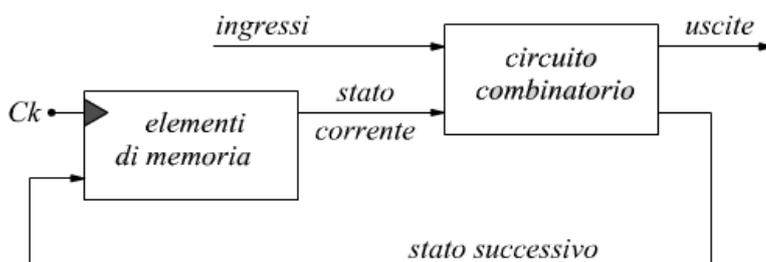
Come per le reti combinatorie, esistono delle procedure di sintesi anche per i circuiti sequenziali sincroni.
