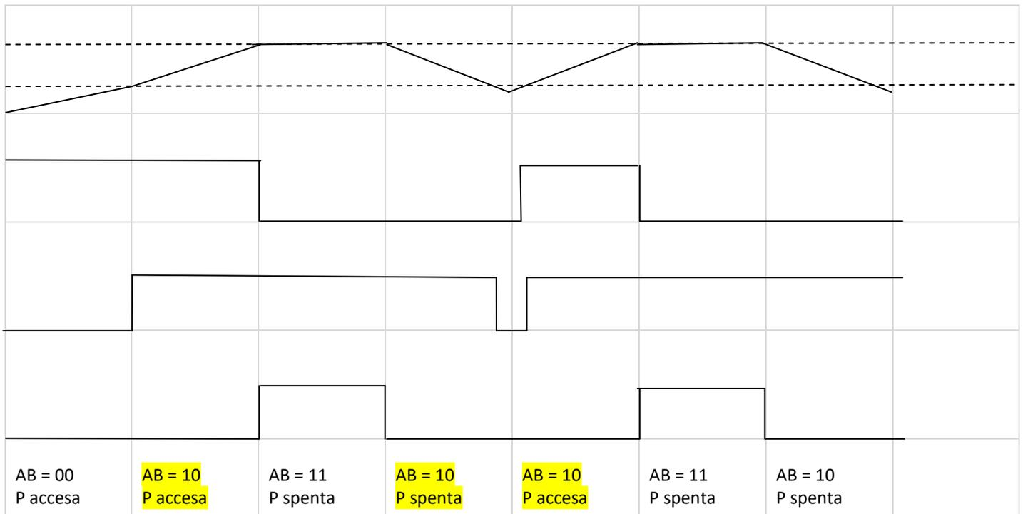
Il FF S-R deve memorizzare quando il livello dell'acqua passa da  $h(t) < h_{\min}$  a  $h(t) > h_{\min}$  e mantenere l'informazione finchè il livello dell'acqua non ritorna sotto  $h_{\min}$ .
