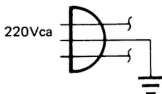
Questo simbolo indica normalmente un cavo di alimentazione a 220Vca. Il conduttore con il simbolo di massa indica il conduttore di terra *verde*.
