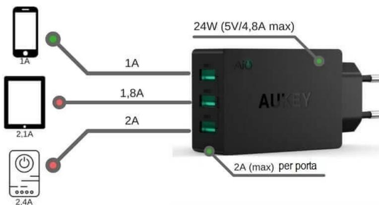
Caratteristiche tecniche Caricatore USB 24W
