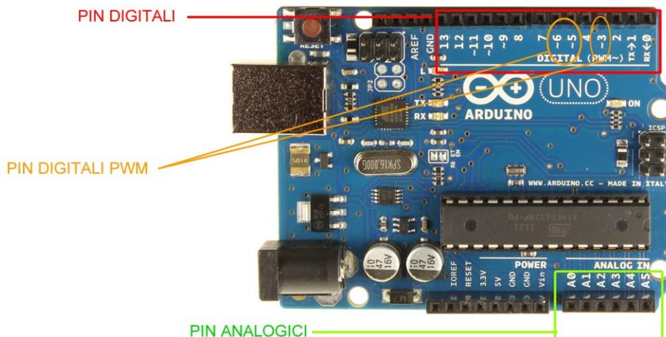
Con un pin PWM è possibile generare in uscita un segnale analogico da 0-5V con una risoluzione di 8 bit ( $5/255 \text{ volt} \approx 0,02V$ ). Un segnale PWM (pulse wide modulation) è in termini molto semplicistici, un onda quadra 0-5V (ad alta frequenza) con delle durate prestabilite per la parte alta (5V).
