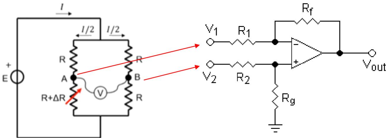
Se scegliamo  $R_1 = R_2$  e  $R_f = R_g$  abbiamo:  $V_{out} = (R_f/R_1) * (V_2 - V_1)$ .
