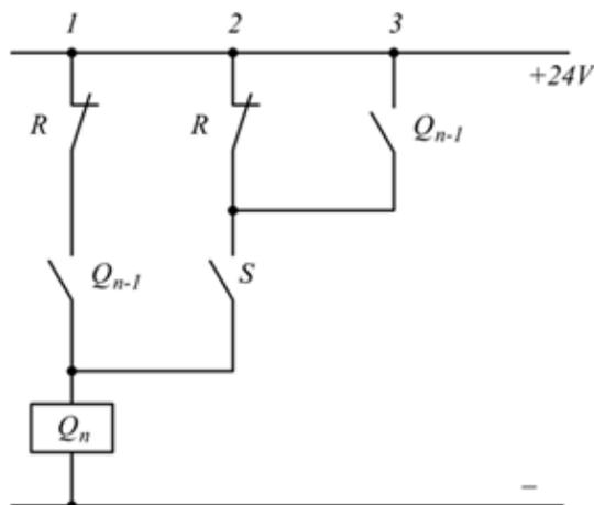
Le memorie elettriche (ed elettroniche) si dicono **asincrone** quando lo stato delle uscite varia direttamente al variare dello stato degli ingressi.
