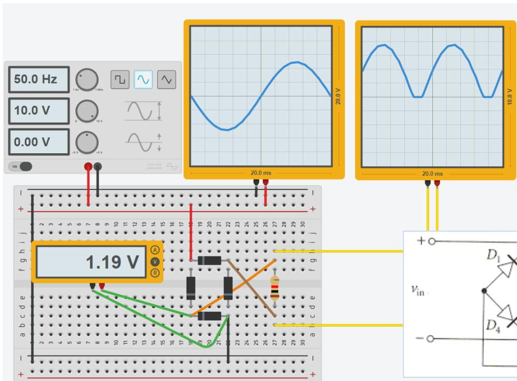
Notare che ci sono sempre due diodi attivi e di conseguenza solo quando viene superata il doppio della tensione di soglia di un diodo la tensione arriva in uscita.
