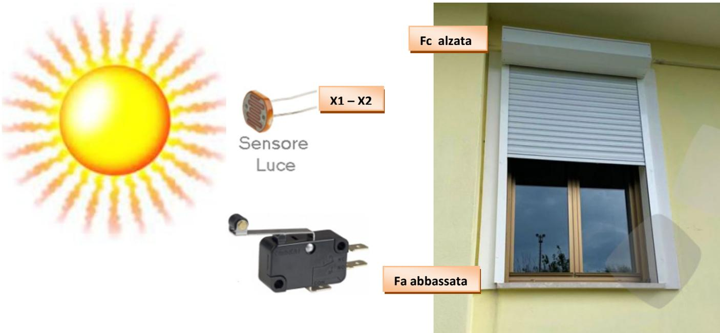
Il sistema impiega un sensore S per rilevare l'intensità luminosa (e un ADC a 2 bit per ottenere 4 livelli di luce) e due finecorsa meccanici Fa e Fc per sapere se la tapparella è ABBASSATA o ALZATA.
