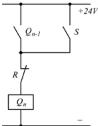
In elettrotecnica, questo circuito viene definito "autoritenuta a disattivazione prevalente" perché prevale il RESET sul SET.
