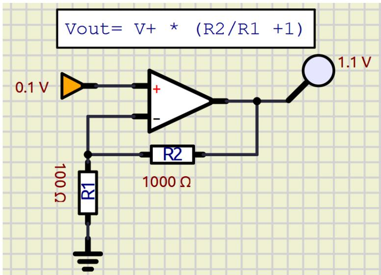
Esempio amplificazione segnale da un partitore di tensione.
