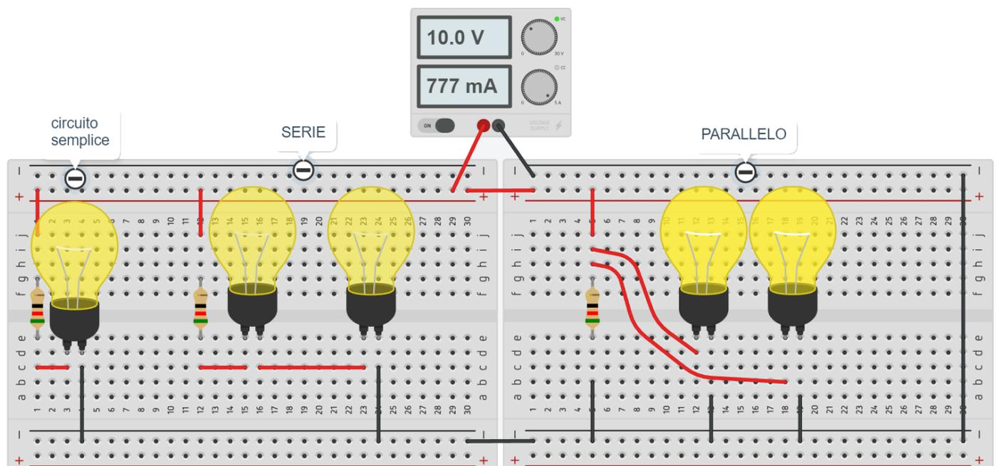
Il generatore di tensione sta erogando una corrente di 777mA (0,777A).
