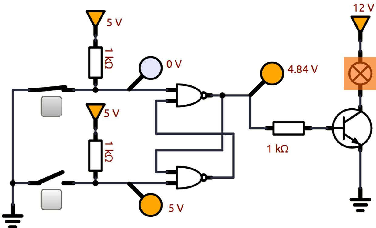
Il circuito consente i comandi separati per la marcia e l'arresto di apparati di potenza.
