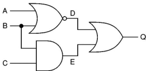
Iniziamo creando una tabella che mostri tutte le possibili combinazioni di input (A, B e C in questo esempio) con un numero sufficiente di colonne aggiuntive per ogni output intermedio (D ed E in questo esempio) e per l'output finale (Q).
