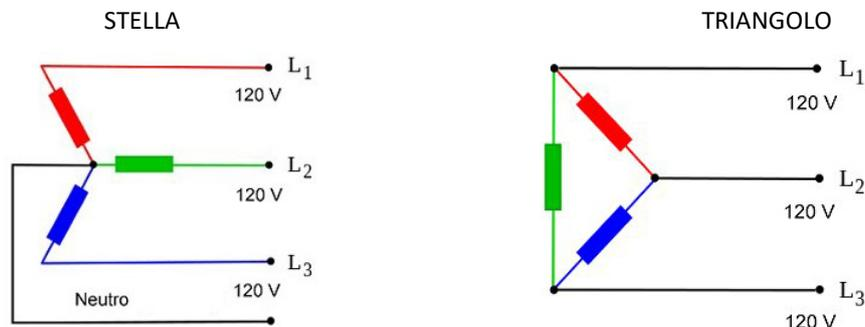
Nel sistema trifase possiamo prelevare la tensione tra fase e neutro (230 V) e tra fase e fase (400 V). Tra fase e neutro abbiamo una differenza di potenziale (tensione efficace) di 230 volt. Tra due fasi abbiamo una differenza di potenziale (tensione efficace) di 400 volt. Matematicamente abbiamo:
