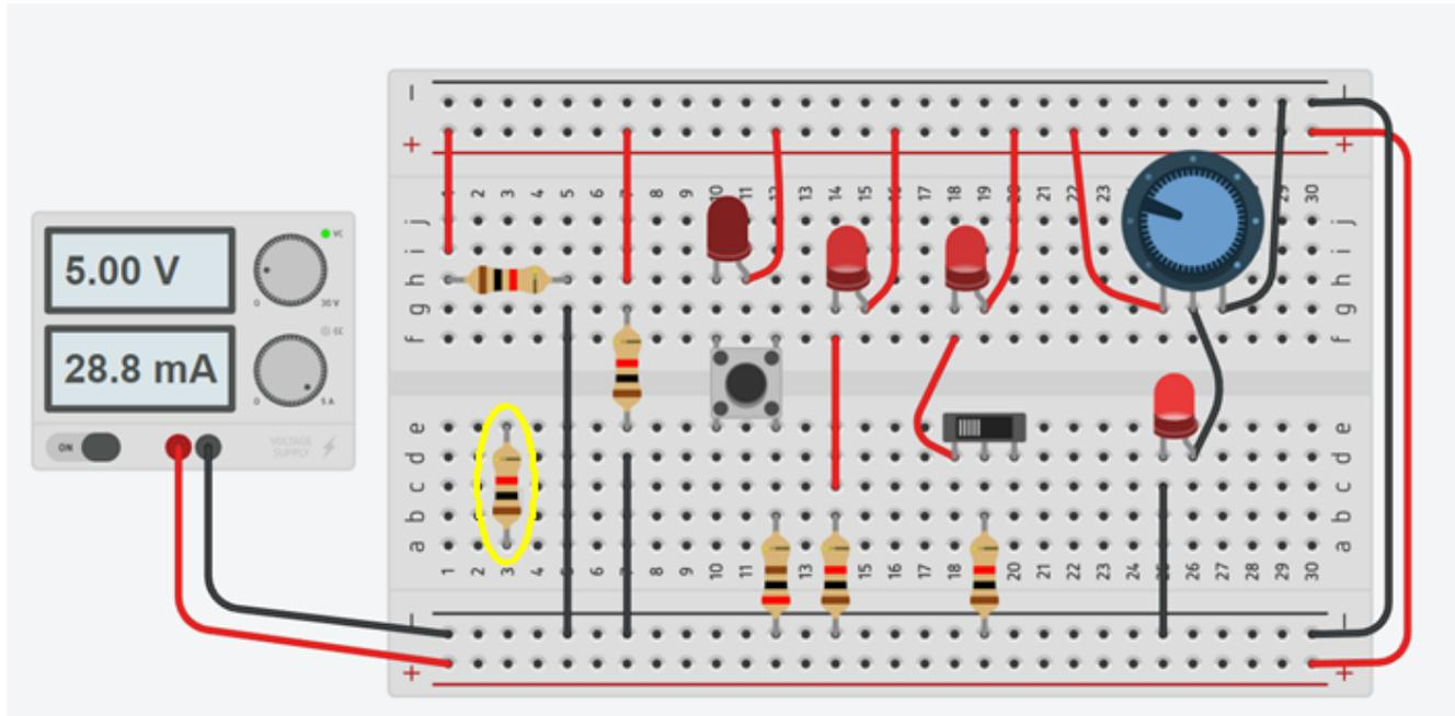
**Attenzione a NON collegare i pin dei componenti in verticale (in giallo) nella breadboard (si crea un cortocircuito!).**
