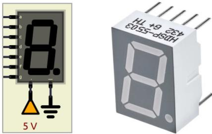
NB: ridurre a 2.4V le tensioni di soglia delle porte logiche e/o aumentare la resistenza del display a 7 segmenti.
